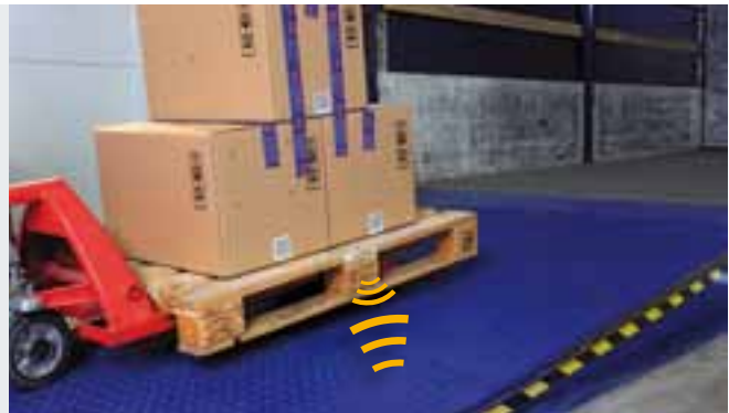
Automatisches Erfassen von Warenbewegungen, einfach beim Überfahren der Ladebrücke.
