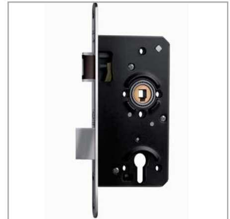
Komfort-Flüsterschloß Kl. 5 PREMIUM-LINE mit Edelstahlstulp, kugelgelagerter Drückernuß mit Federklemmfunktion. Kasten mit KTL-Beschichtung "lebenslange Garantie".
